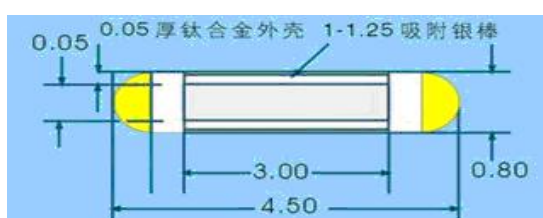
图 9-2 I-125 粒籽源结构示意图
